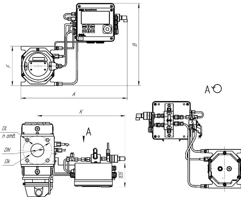
Рисунок 3 Направление потока газа: сверху – вниз
