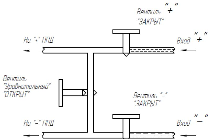
При опрессовке, после подачи испытательного давления в полость комплекса (трубопровода), произвести действия: сначала медленно открыть (открывать в течение не менее 15 секунд) вентиль плюсовой камеры.
