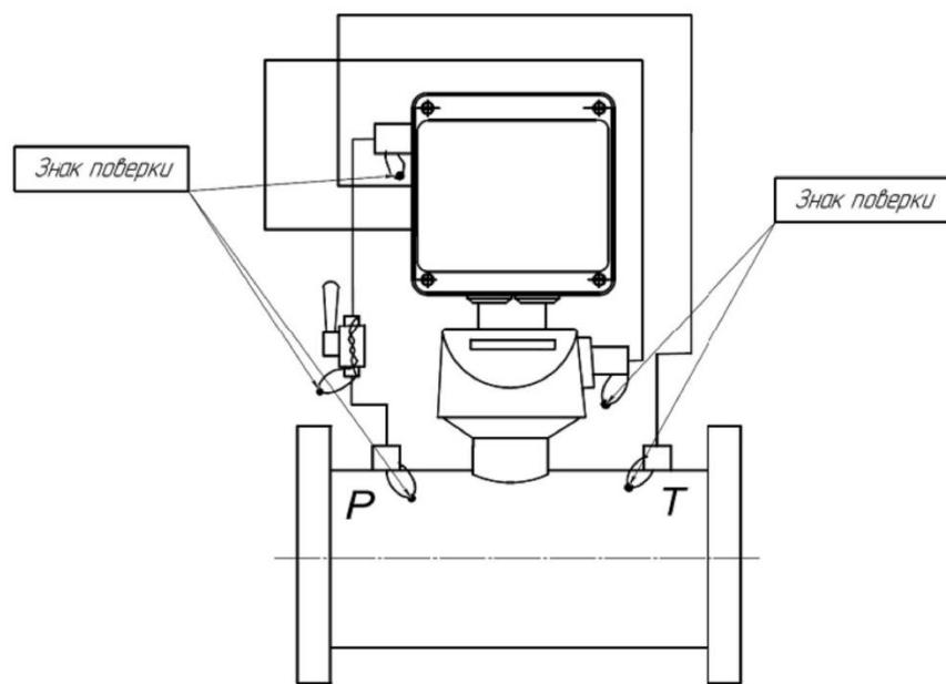
**Схема пломбировки канала отбора давления в местах сращивания трубы комплекса СГ-ЭК с раздельным монтажом корректора и счетчика**
