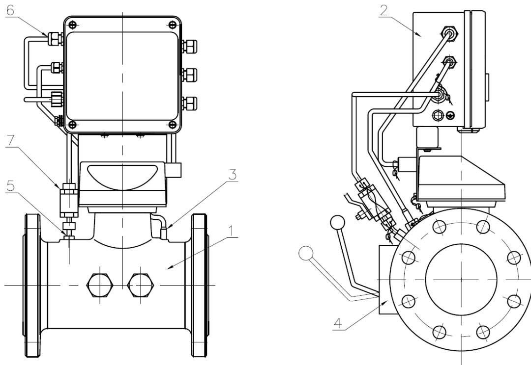
1 - Счетчик газа турбинный РГ-Т
