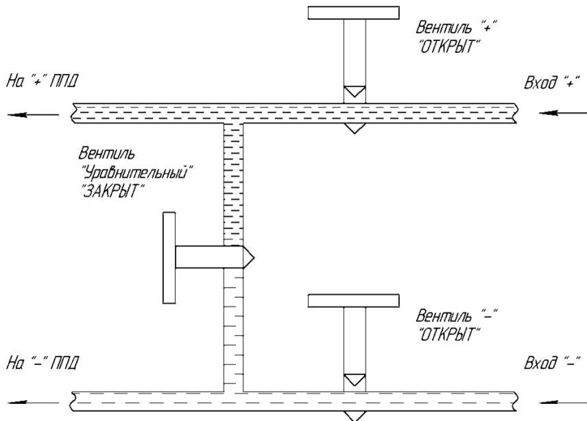
После закрытия уравнительного вентиля проконтролировать перепад давления на счетчике по показаниям корректора ЕК270.
