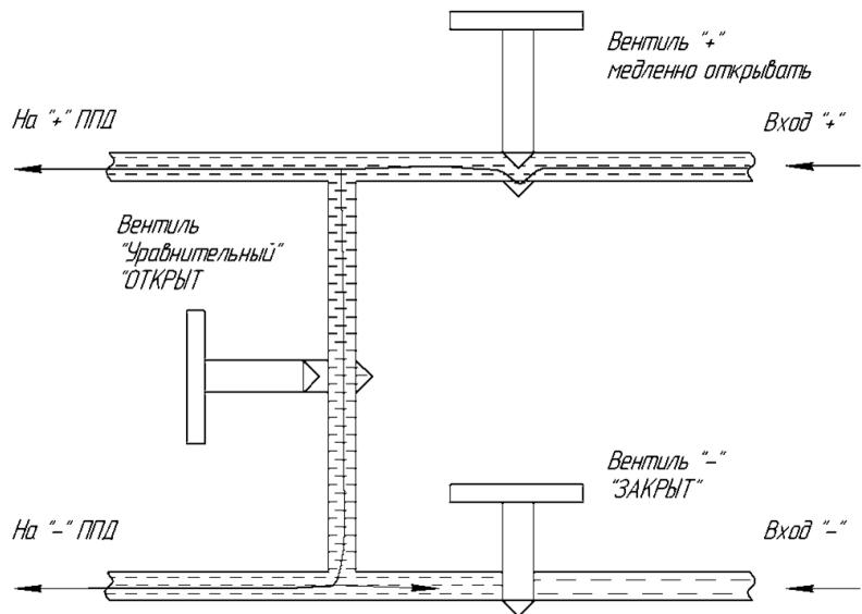
Затем плавно открыть вентиль минусовой камеры, контролируя перепад давления по корректору ЕК270. Значение разности давлений не должно превышать верхний предел измерения ППД, иначе преобразователь разности давлений может выйти из строя. Испытательное давление не должно превышать максимального рабочего давления преобразователя перепада давления – 1,6 МПа.
